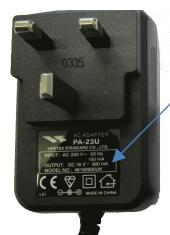
INPUT SHOULD BE 240V AC 50Hz.
