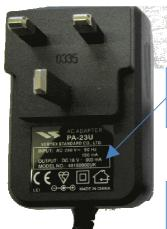
INPUT SHOULD BE 240V AC 50Hz. OUTPUT SHOULD BE BETWEEN 8V AND 16V (IDEALLY 12V-15V) AND CURRENT OF MORE THAN 1 Amp
